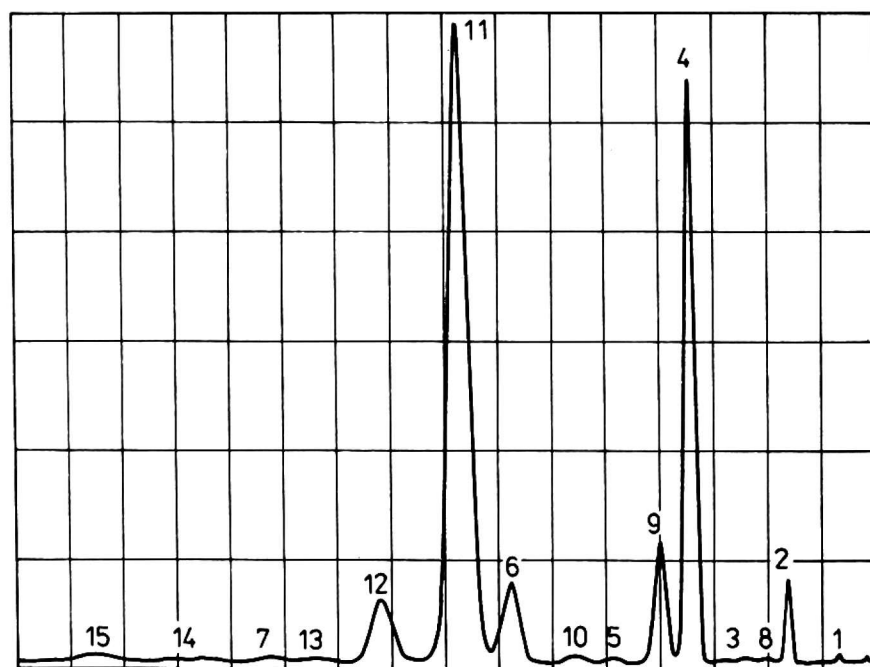
Rys. 1. Chromatogram estrów metylowych kwasów tłuszczowych w mleku loch: 1 - laurynowy, 2 - mirystynowy, 3 - pentadekanowy, 4 - palmitynowy, 5 - margarynowy, 6 - stearynowy, 7 - arachiđowy, 8 - mirystynoleinowy, 9 - palmitoleinowy, 10 - palmitolinolowy, 11 - oleinowy, 12 - linolowy, 13 - linolenowy, 14 - eikozenowy, 15 - eikozadienowy
