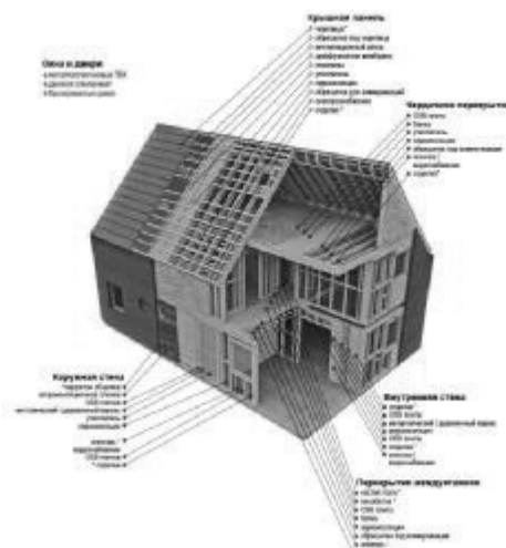
Рис.1. Конструктивное решение дома по каркасной технологии фирмы «АртБуд».
