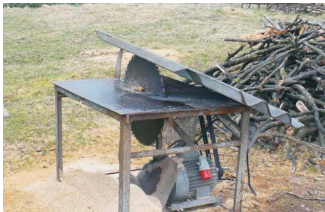
Rys. 1. Pilarka tarczowa (stołowa) wytworzona sposobem gospodarczym
