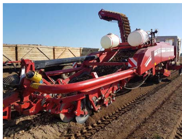
Fot. 7. Kopanie 2-rzędowe bezpośrednio do skrzyń (fot. A. Płotka)
