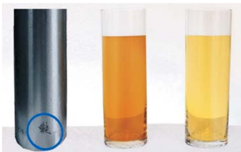
Rys. 5. Magnetyczna filtracja oleju hydraulicznego, widoczne opilki ściernie na rdzeniu magnetycznym
