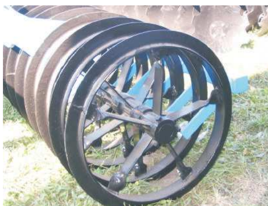
Rys. 6. Wał teownikowy (T-ring) (Mandam) Fig. 6. T-ring shaped roller (Mandam)
