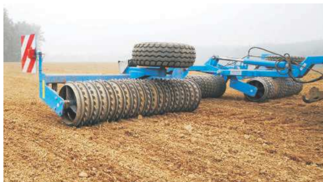
Rys. 1. Wał Cambridge (Farmet) [8] Fig. 1. Cambridge roller (Farmet) [8]
