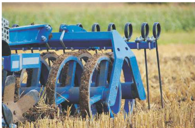
Rys. 7. Wał ceownikowy (U-ring) (Koeckerling) [12] Fig. 7. U-ring shaped roller (Koeckerling) [12]
