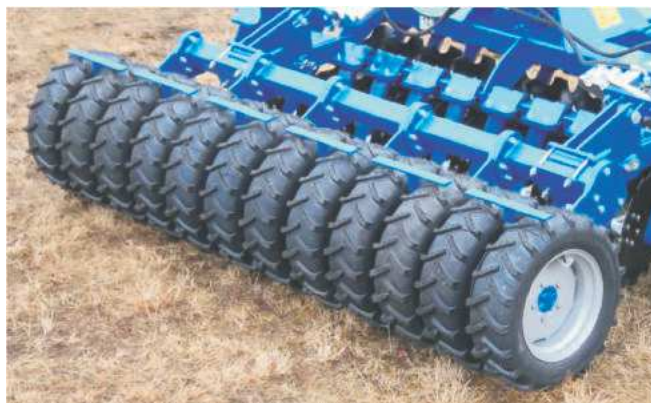
Rys. 11. Wał oponowy (Rolmako) [16] Fig. 11. Tire roller (Rolmako) [16]
