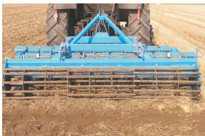
Źródło: opracowanie własne / Source: own study Rys. 2. Wał strunowy rurowy Fig. 2. Tubular string roller
