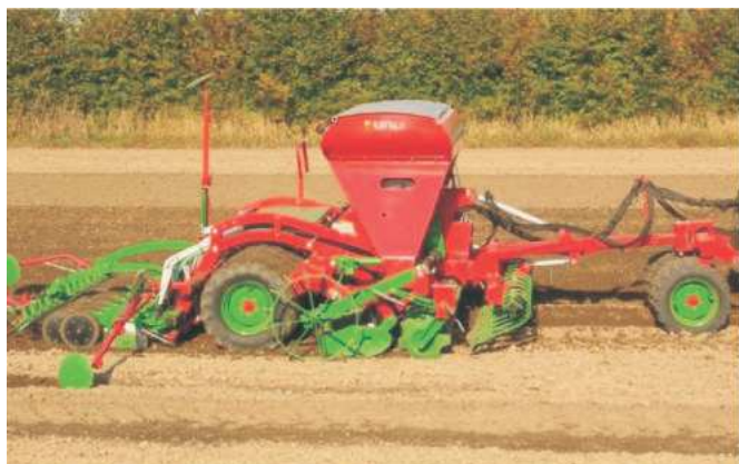
Rys. 12. Agregat uprawowo-siewny z wałami oponowymi (UNIA Sp. z o.o.) [17]
