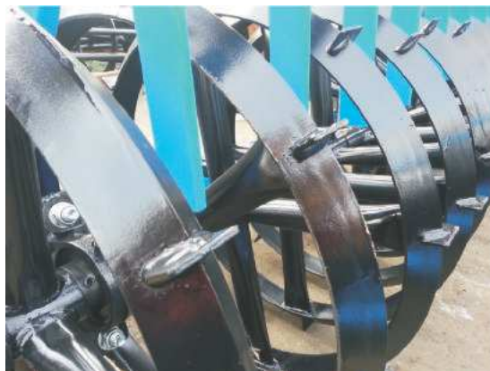
Rys. 5. Wał daszkowy z zabierakami (V-ring) (Mandam) [13] Fig. 5. V-ring roller with scrapers (Mandam) [13]
