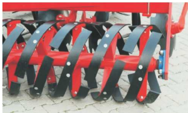
Rys. 10. Wał sprężynowy stopkowy (Ilgitarim) [11] Fig. 10. Foot-spring roller (Ilgitarim) [11]
