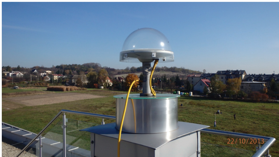
Rysunek 1. Lokalizacja punktu kontrolnego – widok na antenę Zephyr Geodetic Model 2
