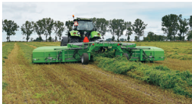
Rys. 6. Zgrabiarka podbieraczowo-taśmowa z mechatronicznym systemem sterowania zespołami roboczymi i rejestracją plonu podczas pracy
