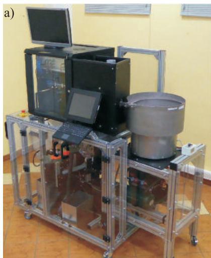
Rys. 1. a) Automat z systemem wizyjnym do skaryfikacji oraz oceny zdrowotności nasion dębu, b) schemat działania Fig. 1. a) Automated vision system for scarification and health assessment of oak seeds, b) operation diagram
