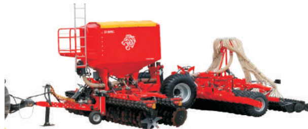
Rys. 4. Agregat uprawowo-siewny o dużej szerokości roboczej do przedsięwziętej uprawy gleby i jednoczesnego wysiewu nasion Fig. 4. The aggregate of large working width for pre-treatment of soil and simultaneous seeds sowing
