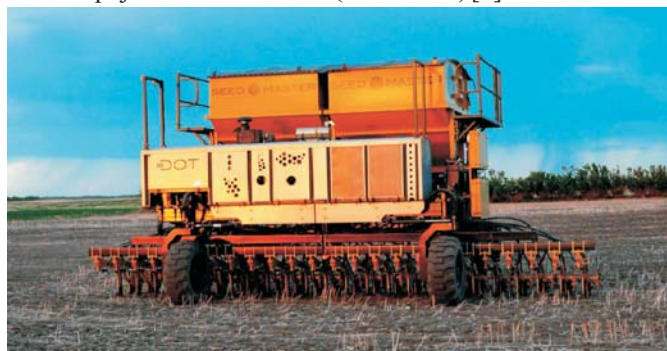
Rys. 6. Autonomiczna rolnicza platforma wielozadaniowa DOT z nabudowanym siewnikiem [3] Fig. 6. DOT autonomous platform with mounted seeder [3]
