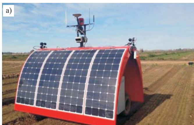
Rys. 8. Autonomiczny pojazd rolniczy Ladybird podstawowe zespoły [7] Fig. 8. Ladybird autonomous vehicle construction [7]
