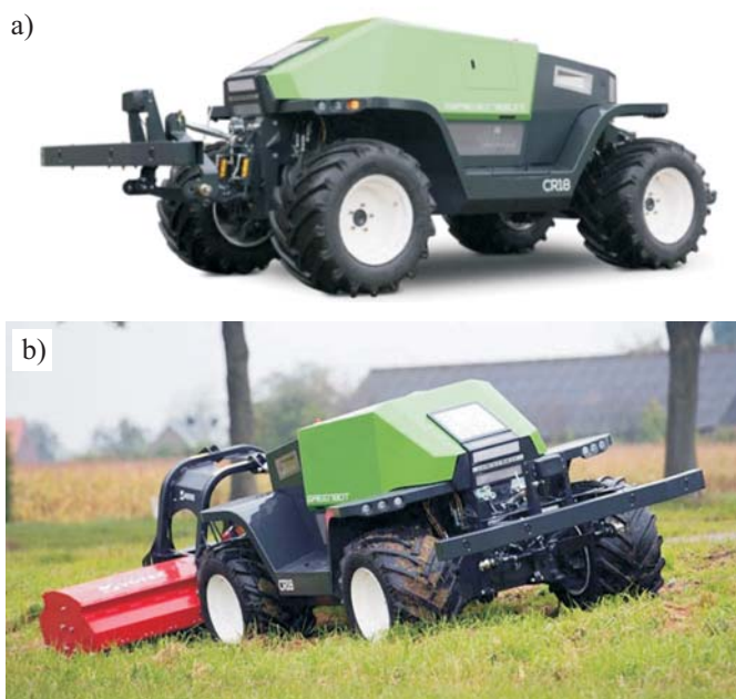
Rys. 4. Autonomiczny ciągnik Greenbot podczas przejazdu transportowego (a) i w trakcie wykonywania zabiegu agrotechnicznego (b) [1]
