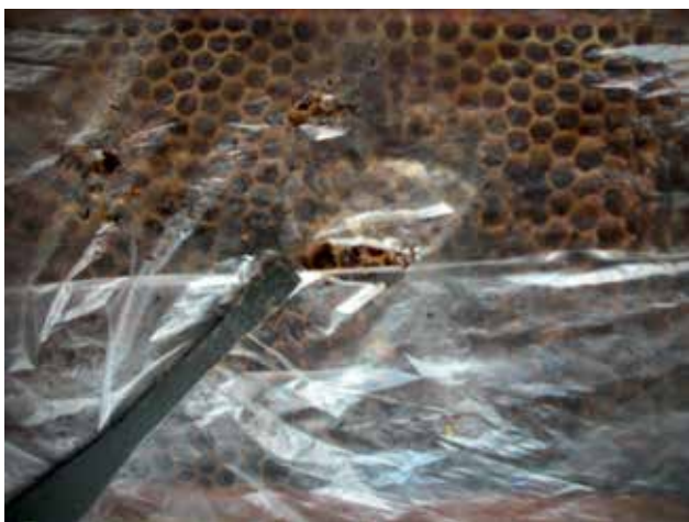
Ryc. 2. Otwory w folii polietylenowej (LDPE). Fot. M. Jeliński.
