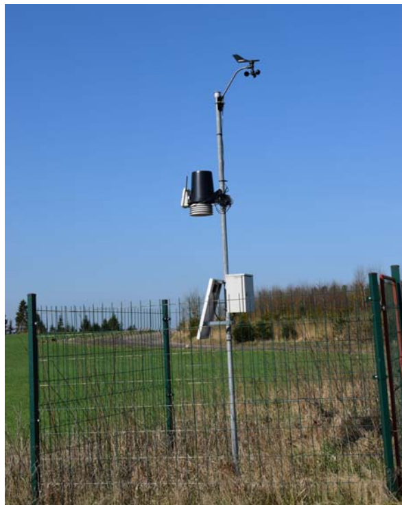
Fot. 1. Stacja meteorologiczna połączona z systemem wspomagającym decyzje w ochronie przed zarazą ziemniaka (fot. G. Manowski)
