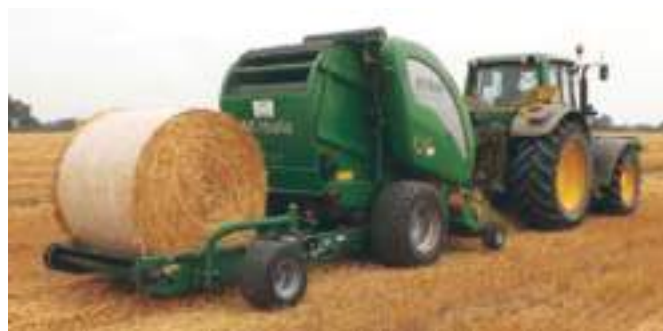
Rys. 2. Wózek agregowany z prasą ogranicza liczbę przejazdów po polu podczas zbioru słomy [15]
