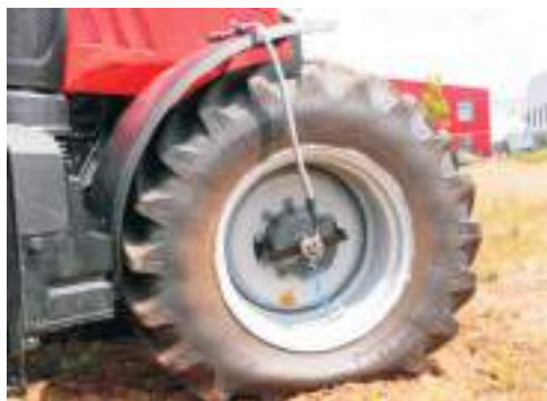
Rys. 6. Centralny układ przyspiesza regulację ciśnienia w oponach [21]
