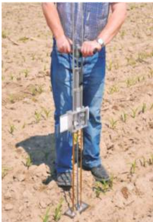
Rys. 1. Penetrometr umożliwia pomiar zwięzłości gleby na różnych głębokościach
