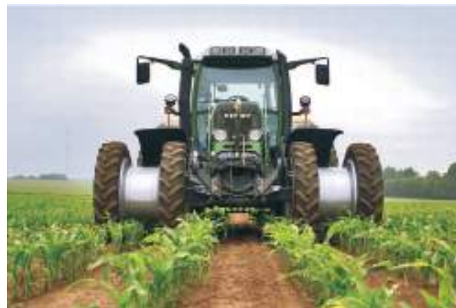
Rys. 7. Koła bliźniacze ograniczają zagęszczenie gleby w międzyrzędziach roślin [22]
