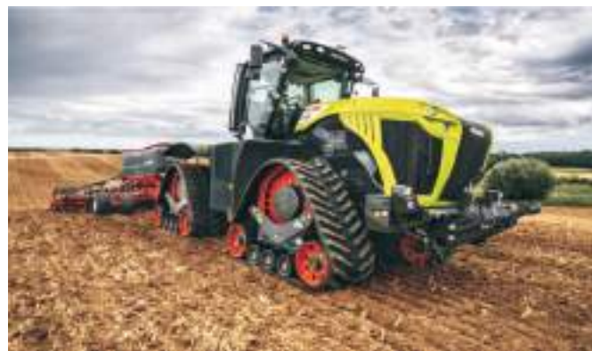
Rys. 8. Gąsienicowy układ jezdny to mniejsze ugniatanie gleby i poślizgi [14]
