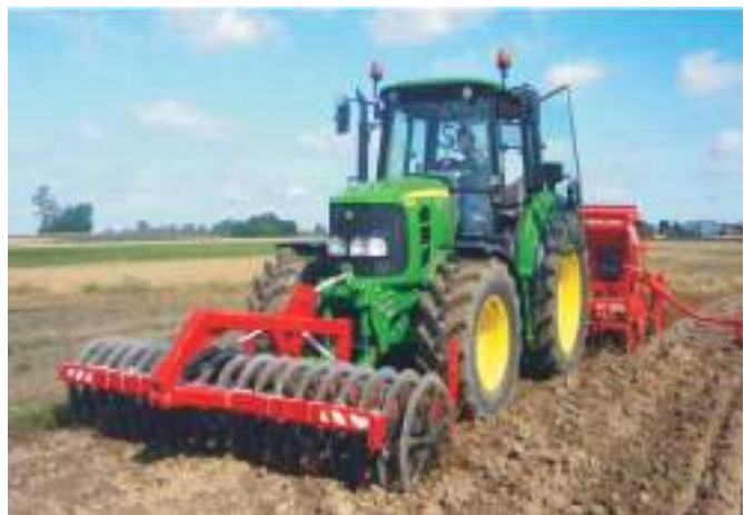
Rys. 10. Wał Campbell umożliwia zagęszczenie pulchnej gleby przed ciągnikiem [16]
