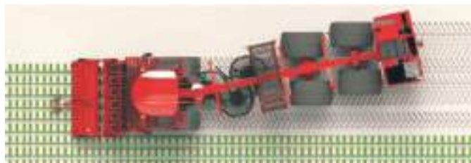
Rys. 9. Jazda kombajnem buraczanym w trybie „psiego chodu” eliminuje pokrywanie się śladów kół [19]
