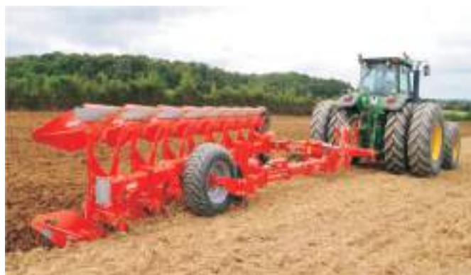
Rys. 11. Ślady kół w bruzdach można wyeliminować wykonując orkę sposobem „on land” [20]
