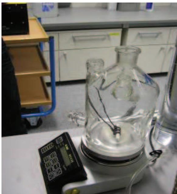
**Рис. 1.** Общий вид стандартного лабораторного биогазового ферментера (BOKU, Австрия)
