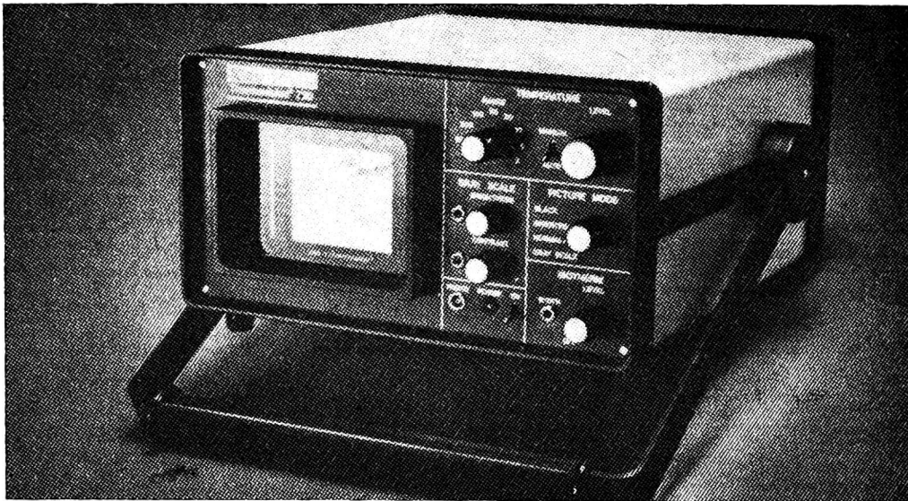
Rys. 3. Urządzenie do odtwarzania obrazu rejestrowanego przez kamerę AGA 750
