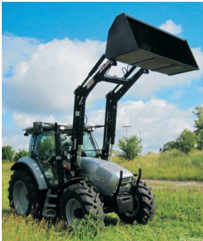
Rys. 3. Ładowacz czołowy Ł-106A produkowany przez Zakład Metalowy AGROMASZ Gruszczewski Janusz w Mrągowie Fig. 2. Ł-106A Front Loader manufactured by Zakład Metalowy AGROMASZ Gruszczewski Janusz, Mrągowo (Poland)
