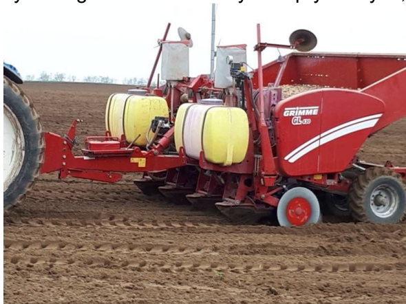
Fot. 3. Zestaw do sadzenia z fabrycznie zamontowaną zaprawiarką
