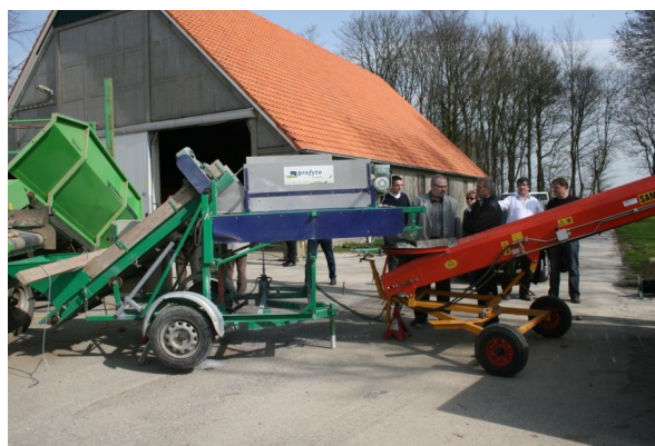
Fot. 6. Mobilny zestaw do zaprawiania bulw wykorzystujący technikę ULV (fot. Bayer)
