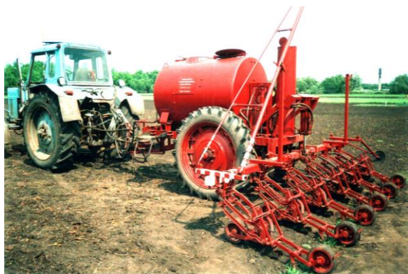
Рис. 1 Общий вид посевного агрегата для высева пророщенных семян
