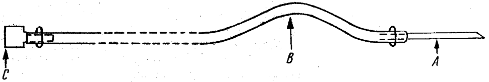
Ryc. 1. Cewnik. A: część cewnika z półsztywnej rurki polyetylenowej, B: część cewnika z gumy silikonowej; C: korek z plastiku.
