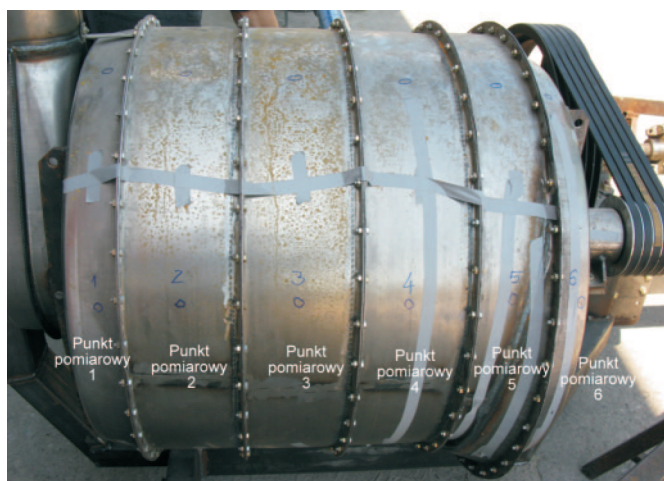
Rys. 3. Punkty pomiaru temperatury na obudowie prototypowego wentylatora pięciostopniowego Fig. 3. Points of temperature measurement on a chassis of prototype five-stage fan
